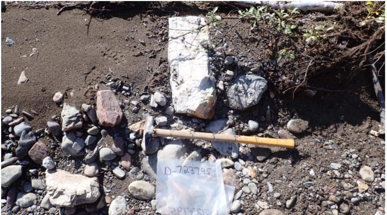
Weitere 3 Meter vertikal unterhalb der zuletzt entnommenen Probe bestand die Float-Probe D-723796 aus einer massiven Quarzkarbonat-Ader mit 2-5% vereinzelt Chalkopyrit und ergab 0,55% Kupfer mit 0,68 g/t Silber.
