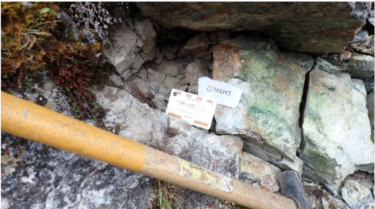
Eine weitere 182 Meter senkrecht verlaufende Grabprobe D-723648 ergab 0,74% Kupfer mit 0,02 g/t Gold und 0,80 g/t Silber. Diese Probe bestand aus weißem Quarz mit geringfügiger Malachit-Kupfer-Alteration und einigen grauen Schluffsteinfragmenten und enthielt 1-2% Chalkopyrit als Flecken. Siehe Tabelle 1 und Foto 3 unten.
