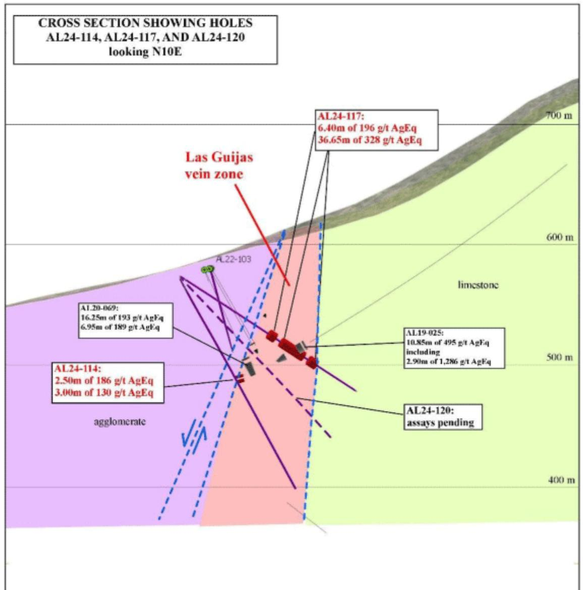
Wie im obigen Querschnitt zu sehen, wurden zuvor unterhalb dieses Treffers einmal 16,25 Meter mit 193 g/t AgEq und 6,95 Meter mit 189 g/t AgEq getroffen. Darunter nochmals 2,5 Meter mit 186 g/t AgEq und 3 Meter mit 130 g/t AgEq. Die Bohrung AL24-120 wurde abgeschlossen, doch die Auswertungen stehen noch aus.
