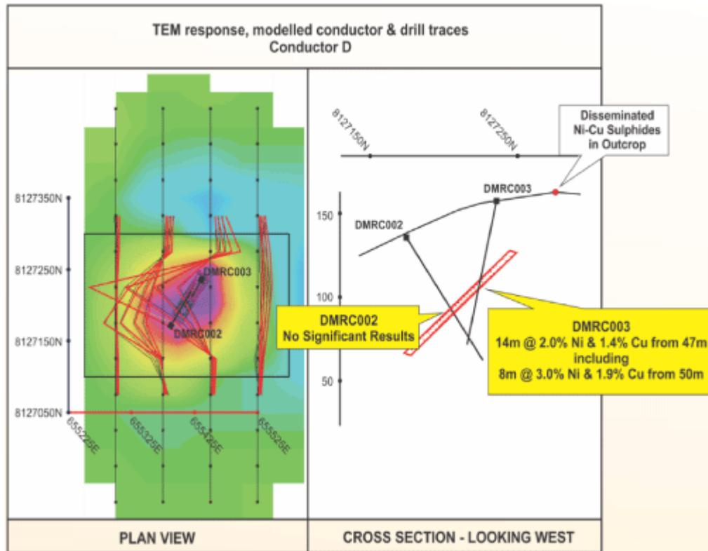
Bereits mit den ersten Bohrungen traf [Buxton](#) auf 14 Meter mit 2% Nickel und 1,40% Kupfer. Das Ganze bereits ab einer Tiefe von nur 47 Metern. In diesem Abschnitt befindet sich noch eine Strecke von 8 Metern mit 3% Nickel und 1,90% Kupfer.
